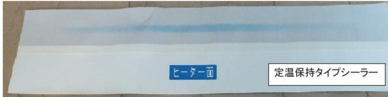
サーモスケール 200C (富士フィルムビジネスサプライ株式会社) を用いた熱分布測定。
