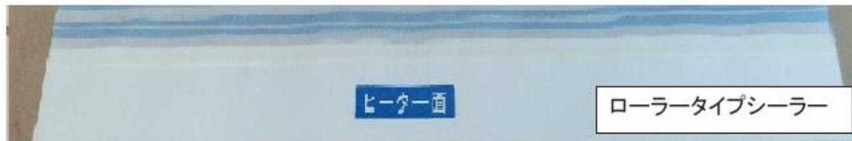
下 : ローラー・タイプ・ヒート・シーラー : 温度むらもなく、良好な熱着を示していた。
